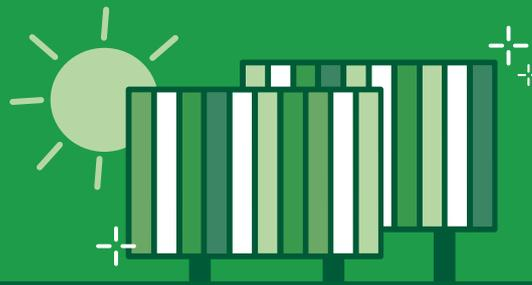
Solarthermie-Anlagen wandeln Sonnenenergie in nutzbare Wärme für die Fernwärmeversorgung um. Durch großflächige Kollektoren wird die Sonnenstrahlung effizient eingefangen und zur Erwärmung von Wasser genutzt.
